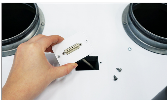
1. 8-pol stikket, som er placeret på toppen af aggregatet, afmonteres og skubbes efterfølgende ned i hullet.
