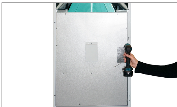
3. Skruer fjernes og dækplade afmonteres.
