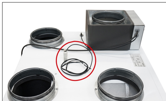
6. T1 føleren trækkes fra 8-pol stik ud i udeluft kanalen (30 cm før forvarmeplade).
